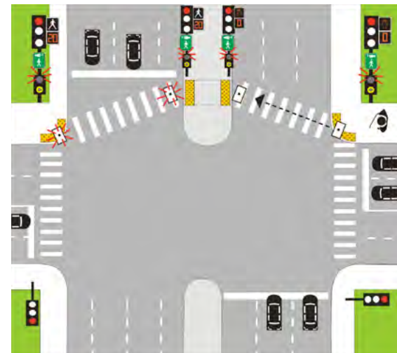
Croquis 3b : Ligne d'arrêt pour les voitures, surfaces avertissantes, signaux sonores avec haut-parleurs bien centrés
