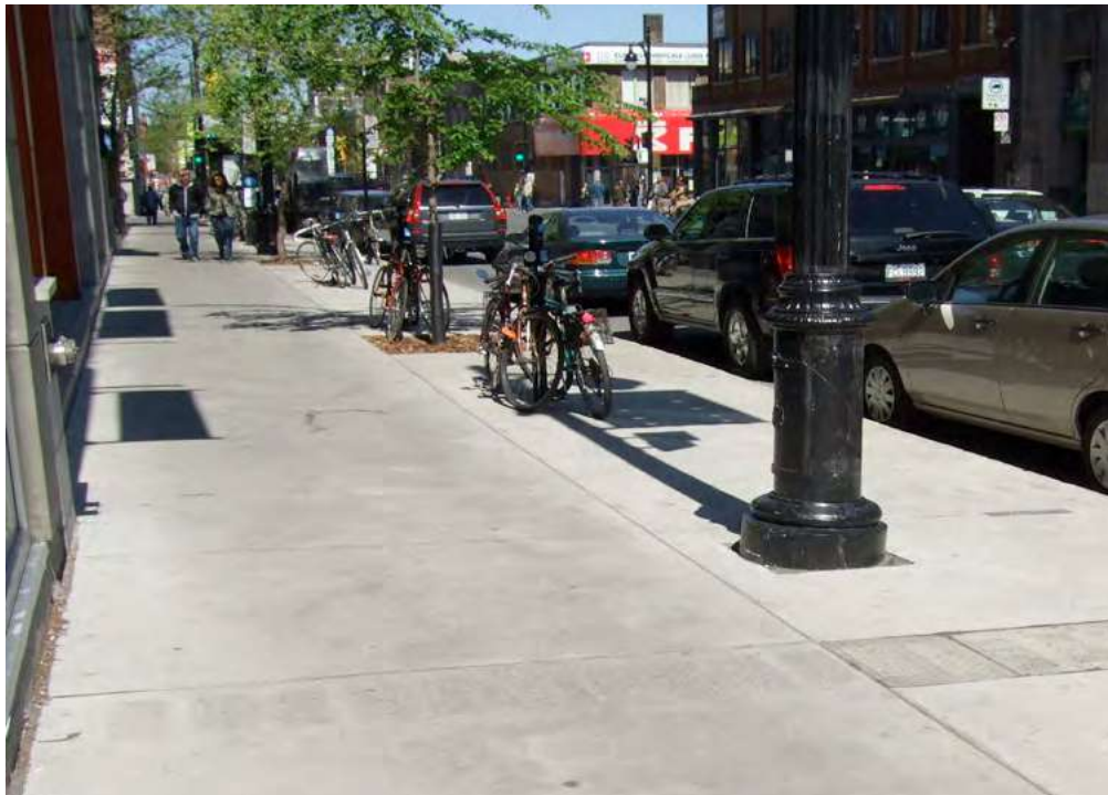
Photo 1 : Mobilier urbain regroupé près de la rue, hors du corridor piétonnier
