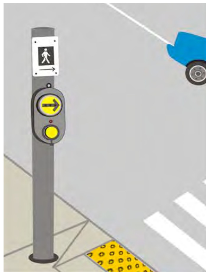
Croquis 21 : Bouton d'appel installé sur un bollard
